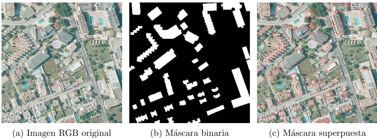
Figura 3.4: Comparativa entre la imagen aérea, su máscara y la validación visual con el perímetro de los edificios superpuesto en rojo.
