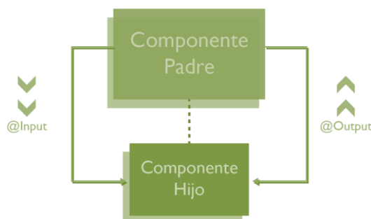
Ilustración 2.15. Esquema Padre-Hijo Angular | Fuente: Elaboración Propia
