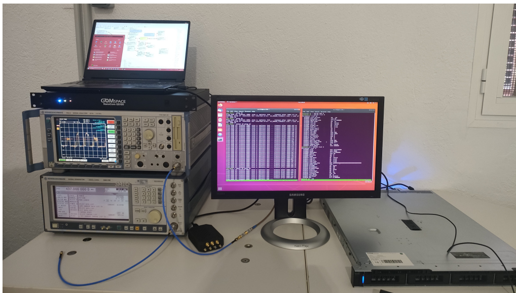
Figura 2.6: Foto de GS, con MS100 a la derecha del monitor y GS100 debajo del portátil.
