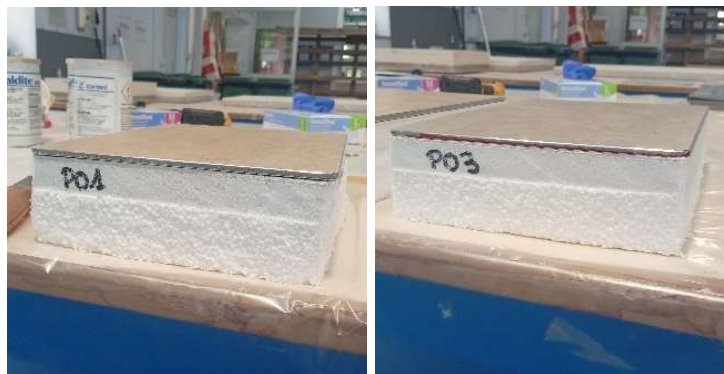
6.7. Muestras del sistema de fachada terminadas.
