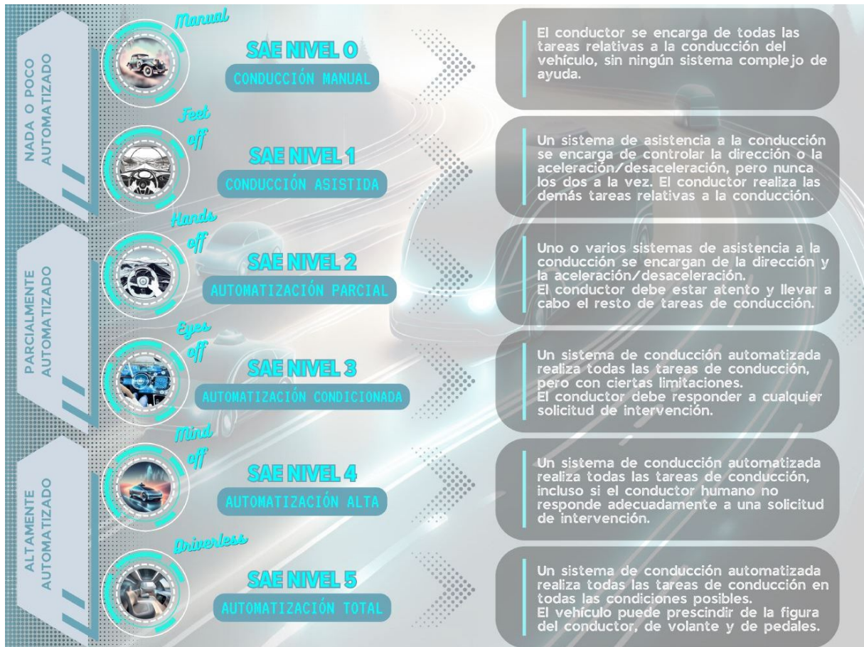
Figura 4: Infografía de la Dirección General de Tráfico (DGT) de los distintos niveles de automatización según la SAE [16]
