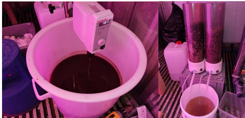
Ilustración 15: Fango y filtros junto al fango filtrado en el sistema desacoplado.
