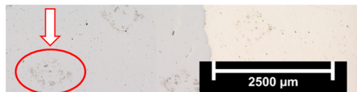
Figura 5.16: Sección de la superficie de observación de la probeta de acero blando fabricada con perfil de tipo 'Verified Density' (Elaboración propia).
