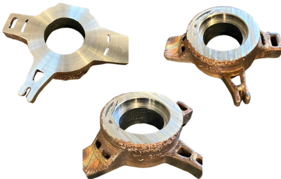
Figura 7.5: Mangueta obtenida de la preforma DED a partir de operaciones de mecanizado en sistema de fabricación híbrida (Elaboración propia).
