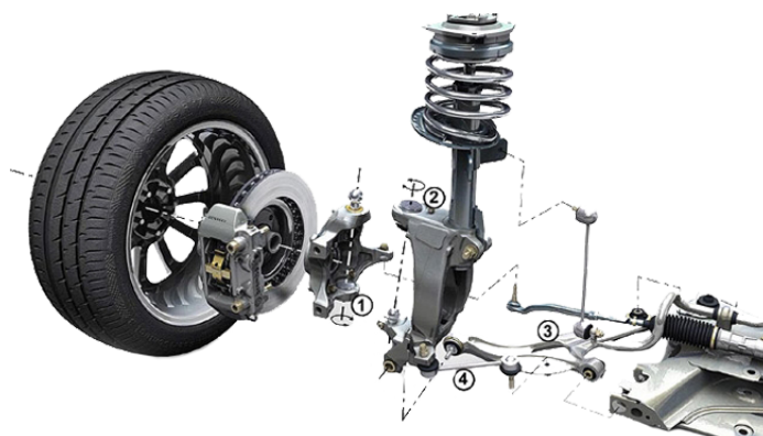
Figura 7.2: Localización de la mangueta (1) dentro del sistema de suspensión y dirección del vehículo (LaSuspensión, s.f.).
