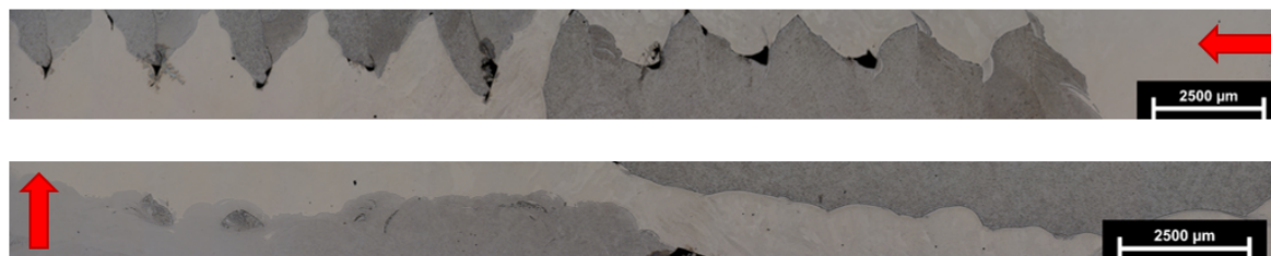
Figura 6.13: Interfases vertical (parte superior) y horizontal (parte inferior) de la probeta multimaterial de la iteración 5, donde las flechas indican la dirección de impresión (Elaboración propia).
