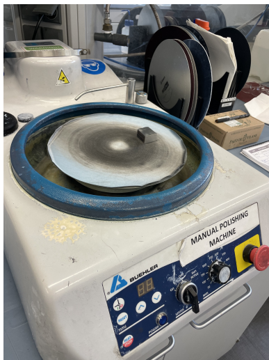
Figura 5.7: Equipo de pulido manual empleado para la preparación de las probetas (Elaboración propia).
