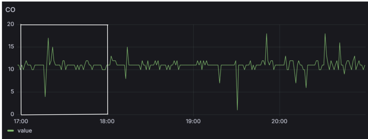
Figura 91: medición del CO en ppm durante la quema del 4 de Noviembre.
