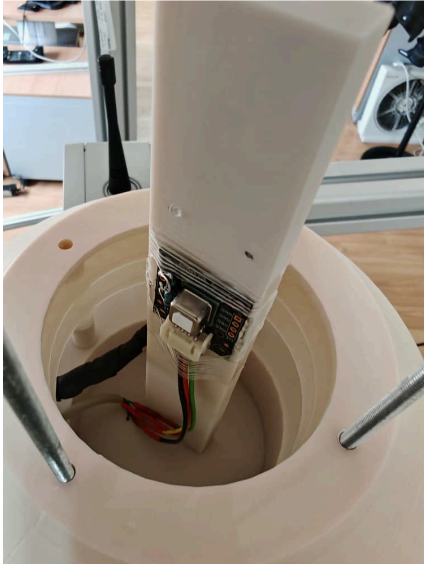
Figura 48: Colocación de los sensores en la base (se fijó con adhesivo y luego se hicieron muescas de atornillado).
