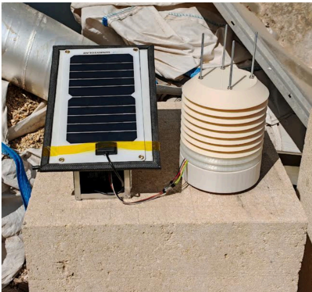
Figura 65: Configuración inicial con el sensor de Temperatura, CO 2 y Humedad
