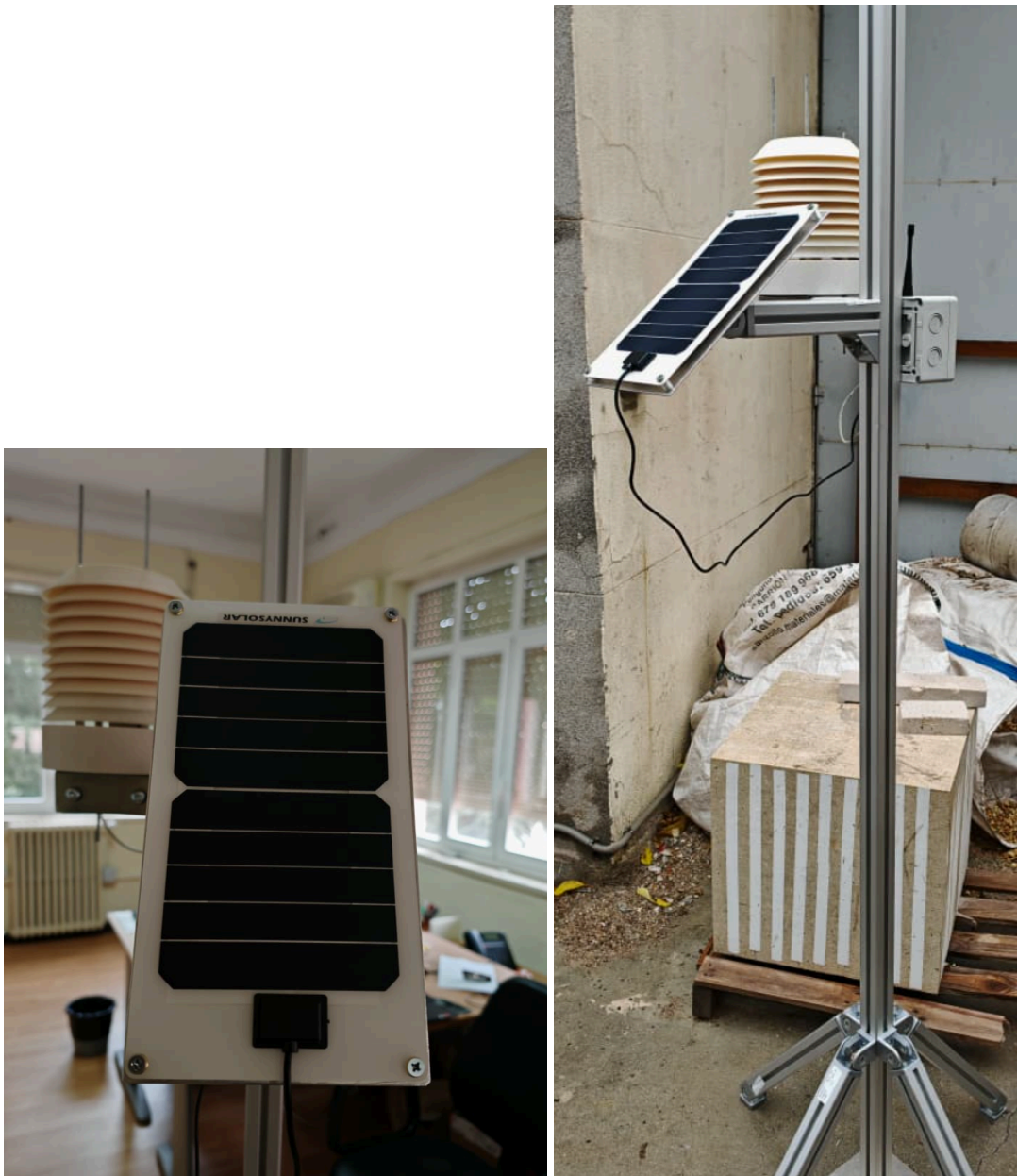
Figura 66: Configuración con el poste y la introducción del sensor MiCS-6814
