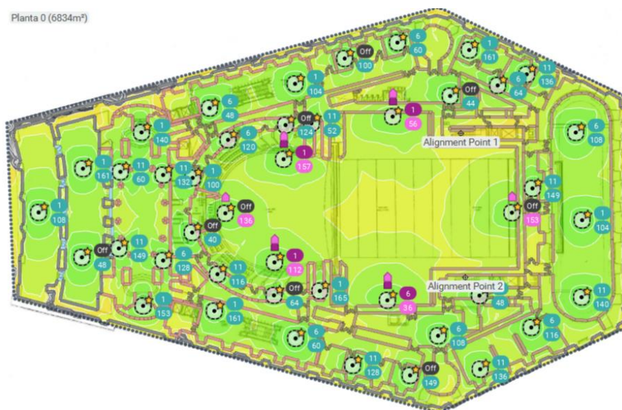
Figura 47. Planta 0: Potencia de la señal (alta densidad)
