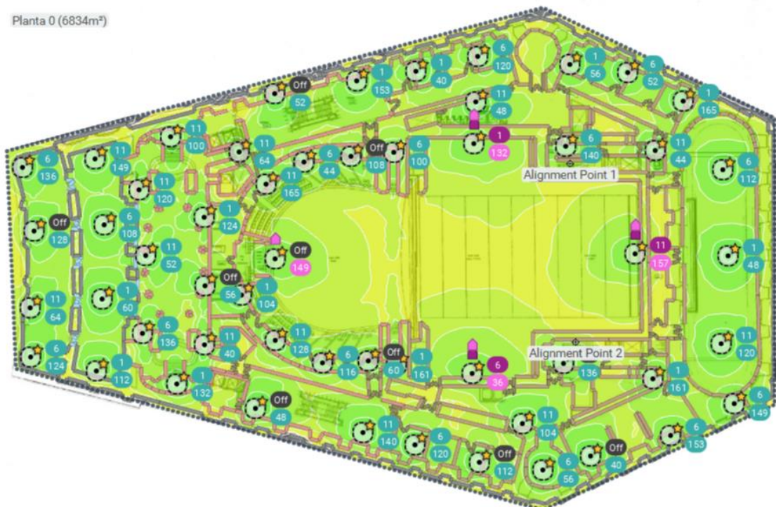
Figura 45. Planta 0: Potencia de la señal (RTLS)
