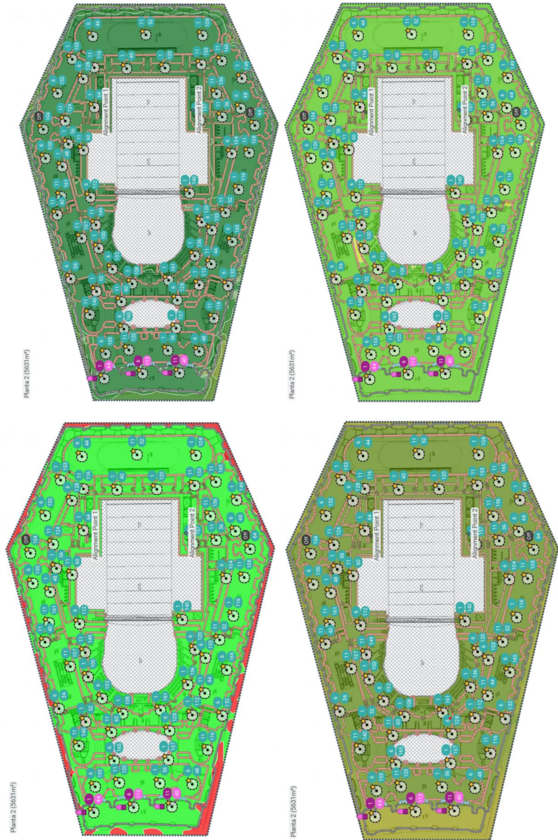
Figura 58. Planta 2: SNR, Interferencia de canal, Salud de la red y Data Rate (RTLS)
