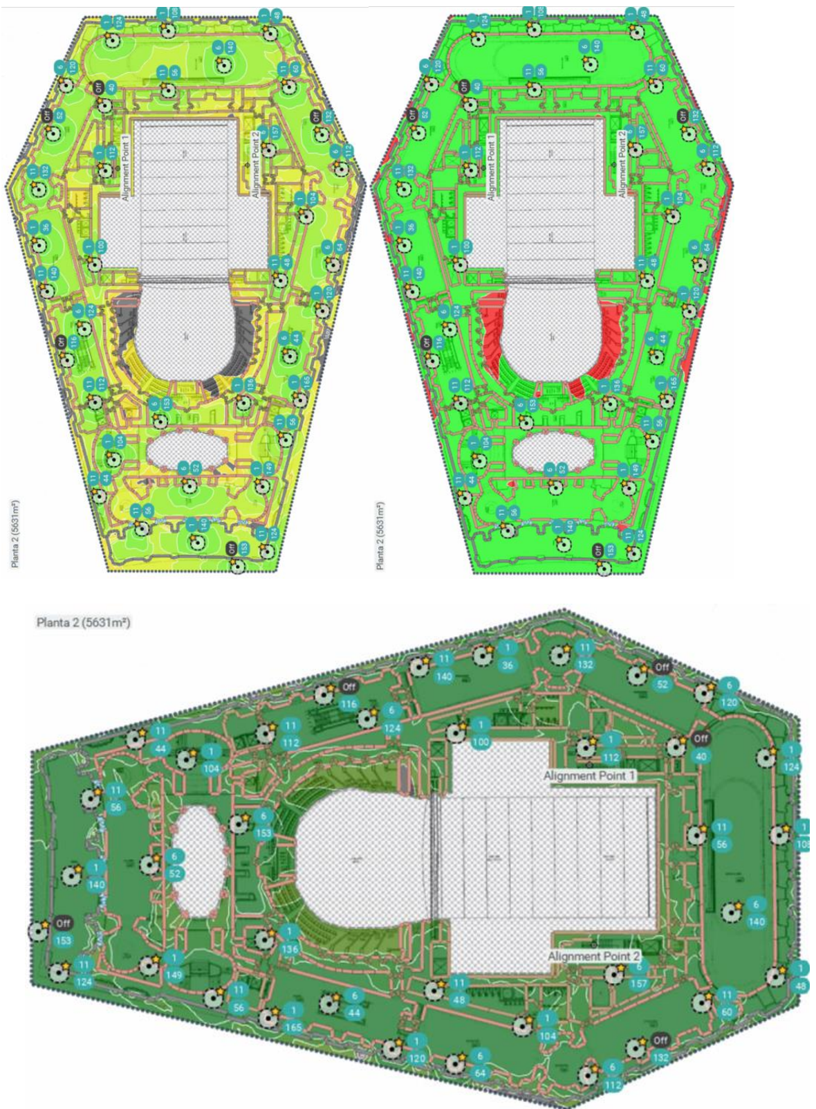
Figura 109. Planta 2: Potencia de la señal, Salud de la red y SNR (nivel básico)
