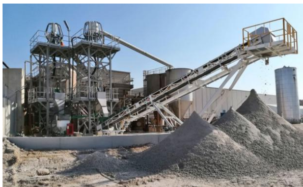
FIGURA 2: PLANTA DE TRATAMIENTO DE ARENAS
