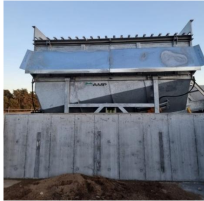
FIGURA 35: TOLVA CON HORMIGÓN COMO BASE ESTRUCTURAL
