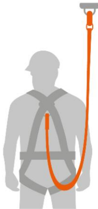
Sistema de conexión
