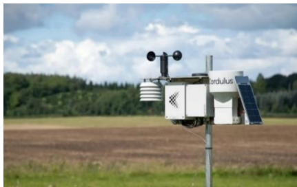
Figura 4 Estación Meteorológica de temperatura, pluviometría, viento y humedad relativa. Fuente: Cordulus
