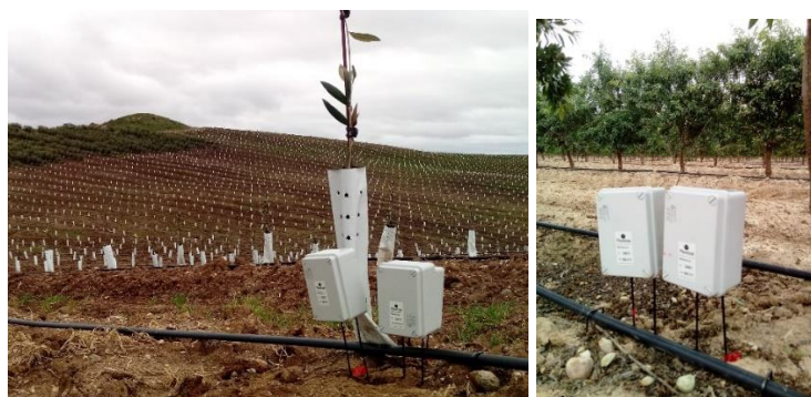
Figura 5 Sensor de humedad de suelo. Fuente: Plantae
