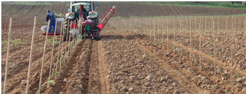
Figura 2 Máquina plantadora suspendida. Fuente: Agrariaolive
