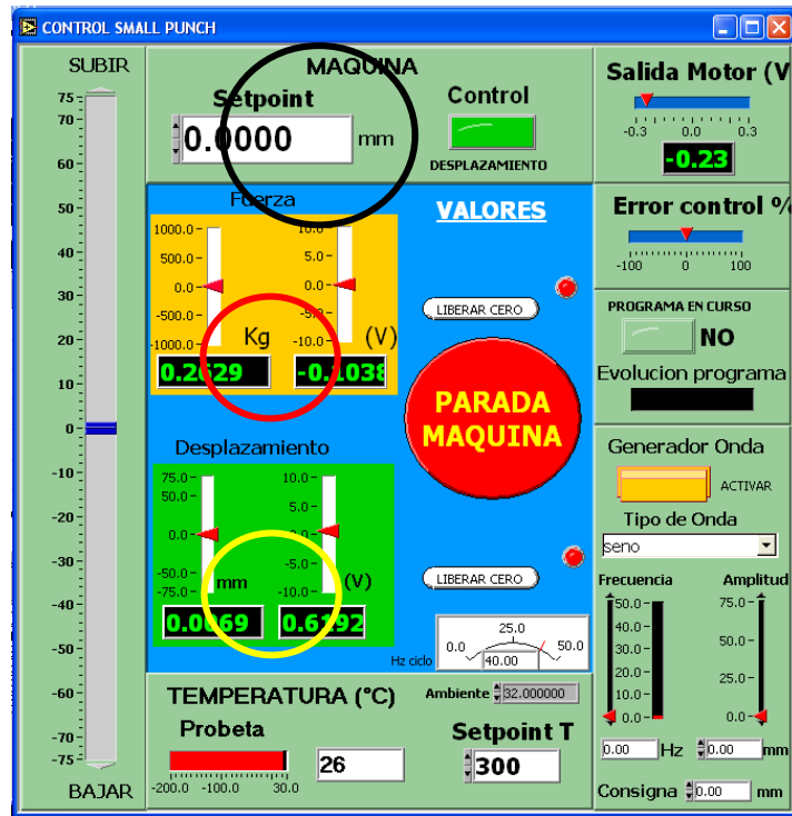
Figura 20. Panel de control de la máquina de ensayos.
