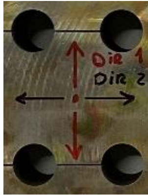
Figura 25. Punto de medida de tensiones residuales.
