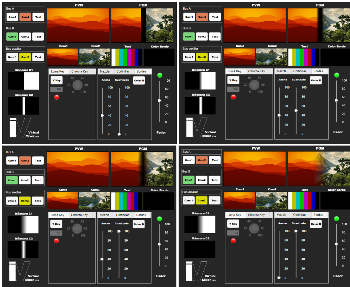
Figura 49. Cortinilla horizontal con borde negro de 40 píxeles y sin suavizado (arriba izquierda), con borde negro con suavizado del 50% (arriba derecha), con borde negro y suavizado del 100% (abajo izquierda) y sin borde y suavizado del 100% (abajo derecha).
