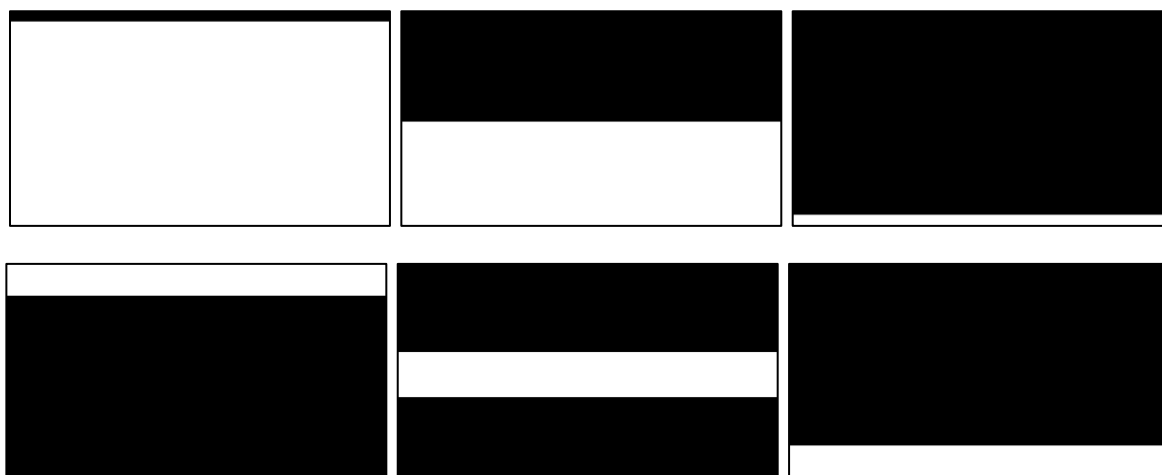
Figura 28. Máscara C1 en diferentes momentos de la transición cortinilla vertical (arriba) y máscara C2 en los mismos instantes (abajo) en función del valor del fader.
