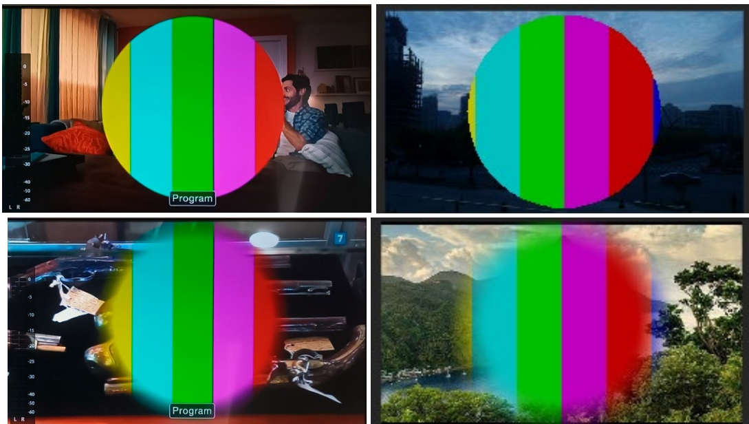
Figura 42. Cortinilla circular con ancho de borde 0 y suavizado 0 en equipo real (arriba izquierda) y aplicación (arriba derecha), y ancho de borde 0 y suavizado 50 en equipo real (abajo izquierda) y aplicación (abajo derecha).
