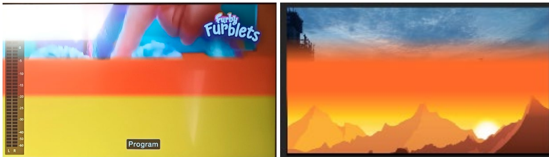
Figura 41. Cortinilla horizontal con ancho de borde 100 y suavizado 50 en equipo real (izquierda) y aplicación (derecha).
