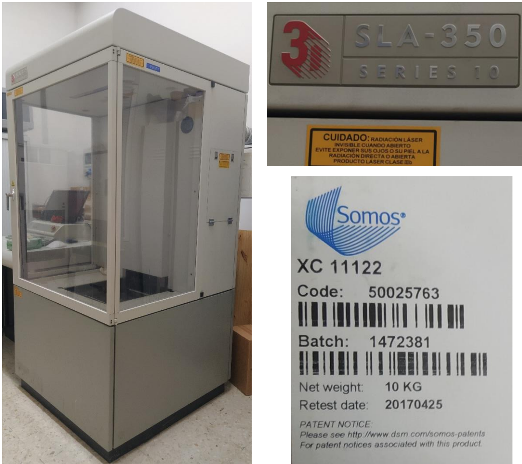
Figura 4.5.1-2: Máquina SLA-3500 de 3D Systems y código de la resina epoxi del Laboratorio de Desarrollo de Producto en la ETSII de la UPM
