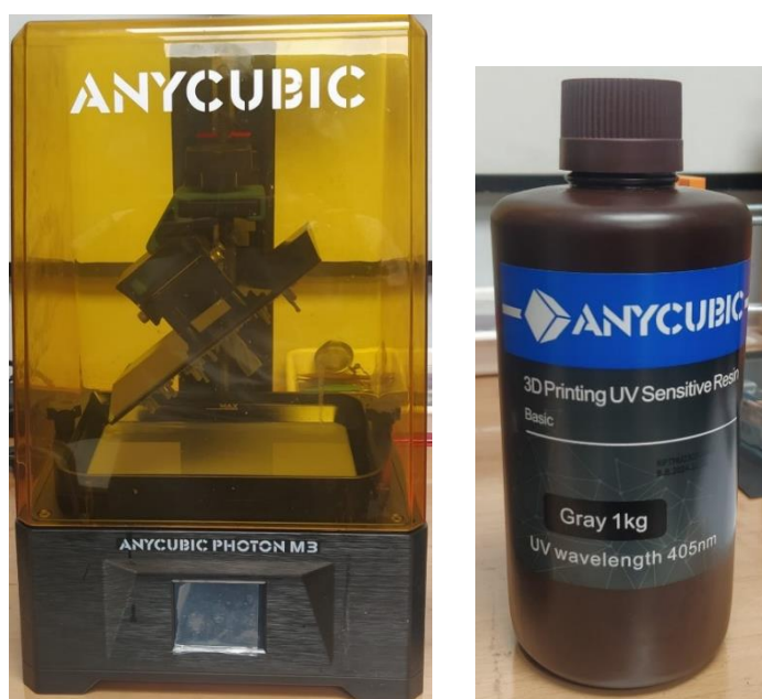
Figura 4.5.2-1: Impresora ANYCUBIC Photon M3 y ANYCUBIC 3D Printing UV Sensitive Resin del Laboratorio de Desarrollo de Producto en la ETSII de la UPM
