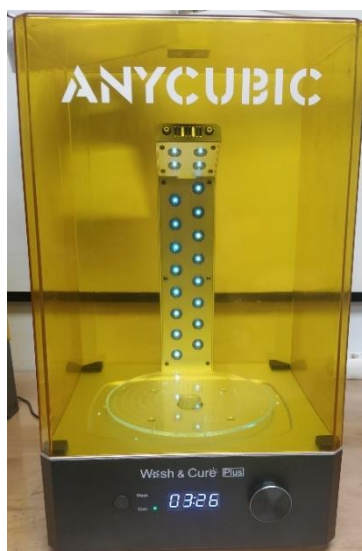
Figura 4.5.2-2: Máquina ANYCUBIC Wash and Cure PLUS del Laboratorio de Desarrollo de Producto en la ETSII de la UPM
