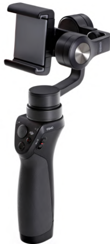
Figura 5.1: Gimbal usado para estabilizar una cámara o smartphone
