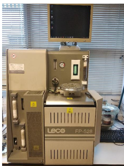
Figura 10: Equipo de combustión Dumas para el análisis de la proteína bruta..
