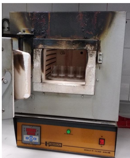
Figura 18: Crisoles introducidos en horno (550°C) para calcinar las muestras y obtener la digestibilidad in vitro de la MO
