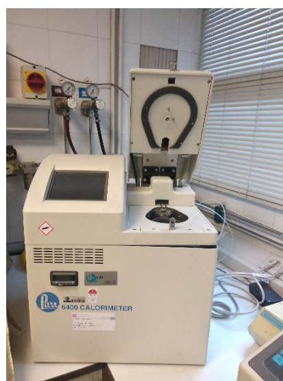
Figura 11: Bomba calorimétrica para extracción de la energía bruta.
