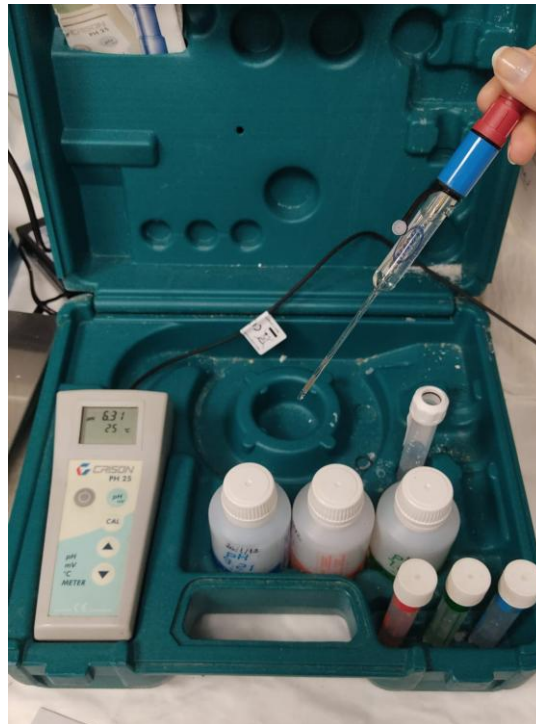
Figura 13: Medidor de pH con electrodo fino.
