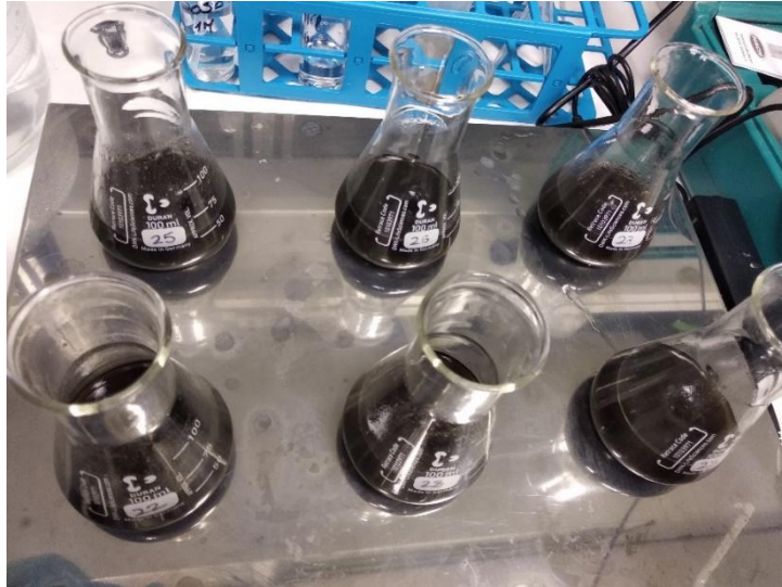
Figura 12: Muestras situadas en la plataforma agitadora para ajuste de pH y proceder a la incubación.
