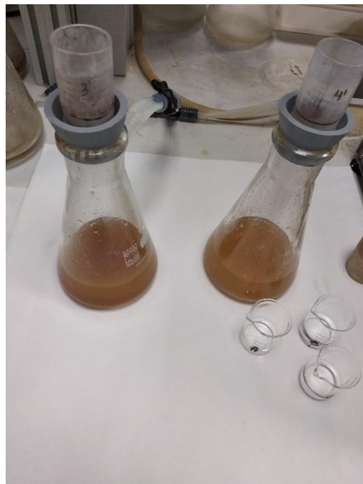
Figura 16: Muestras filtrando con vacío
