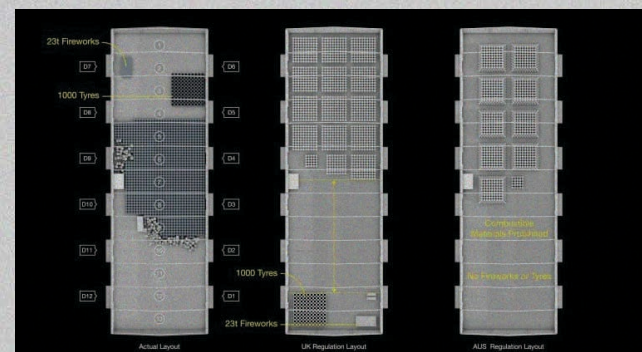
Comparación de la disposición de los elementos almacenados en el almacén 12 y cómo deberían haberse dispuesto según las normativas británica y australiana. Forensic Architecture, 2020. [Fig. 235]
