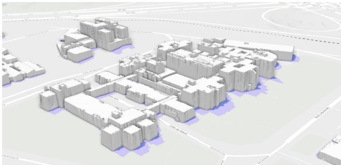
Figura 24. Vista 3D Frecuencia de sombras para el día 20 de junio 2024 (solsticio de verano), entre las 10:00 y 19:00 h, sin considerar la presencia de vegetación. En la imagen de derecha a izquierda: Centro Superior de Diseño de Moda de Madrid (CSDMM); Centro de Informática y Comunicaciones (ETSISI) y Escuela Técnica Superior de Ingeniería y Sistemas de Telecomunicación (ETSIST). Elaboración propia.
