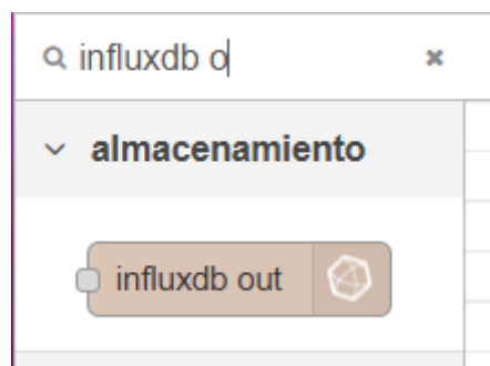
Figura 41: Nodo necesario para la extracción de datos desde Node-Red a InfluxDB.
