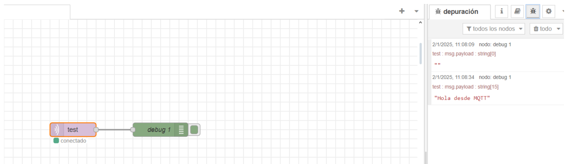
Figura 21: Prueba de recepción de mensaje en Mosquitto con nodo debug.
