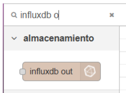
Figura 49: Nodo necesario para la extracción de datos desde Node-Red a InfluxDB.
