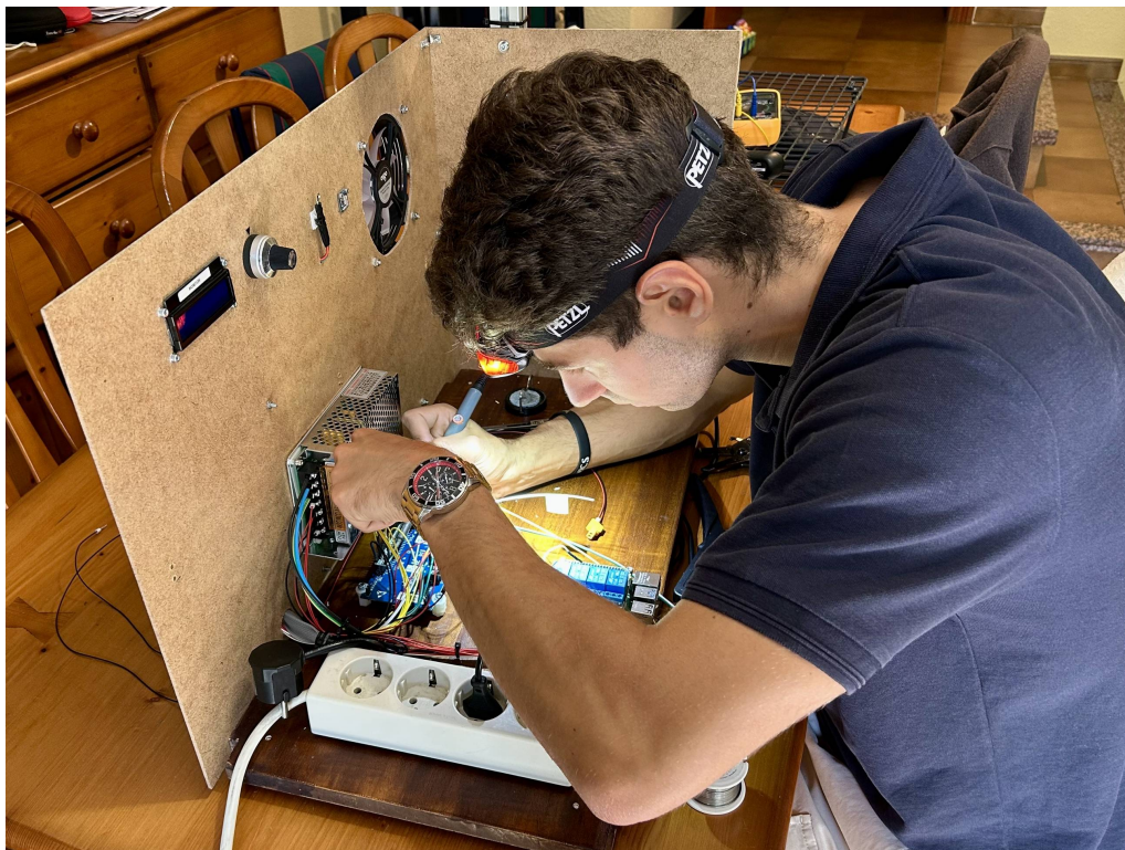
Figura 9.11: Proceso de soldadura de los cables del sistema.
