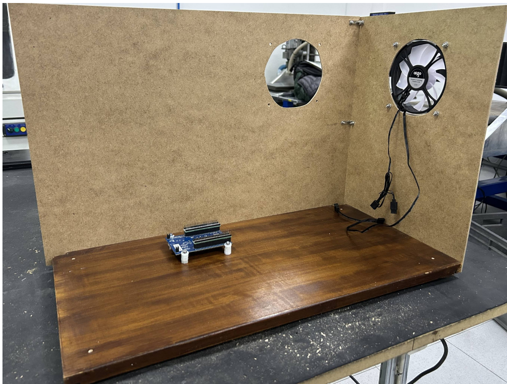
Figura 9.6: Colocación inicial del ventilador en el panel lateral.
