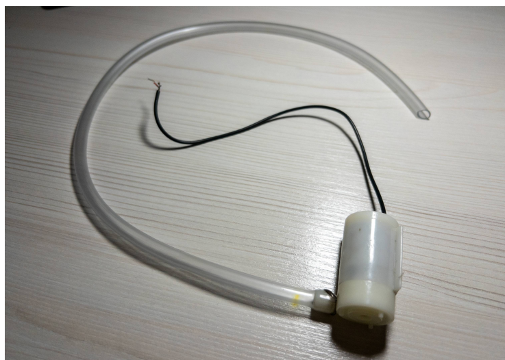
Figura 5.7: Bomba de agua para riego automatizado del invernadero.
