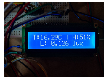
Figura 5.9: Visualización de las magnitudes medidas a través del Display LCD.
