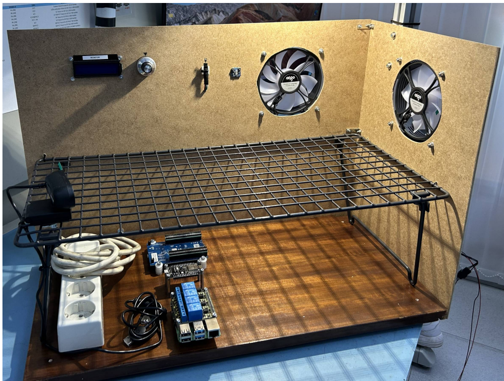
Figura 9.8: Estructura con ventiladores montados y bandeja metálica instalada.
