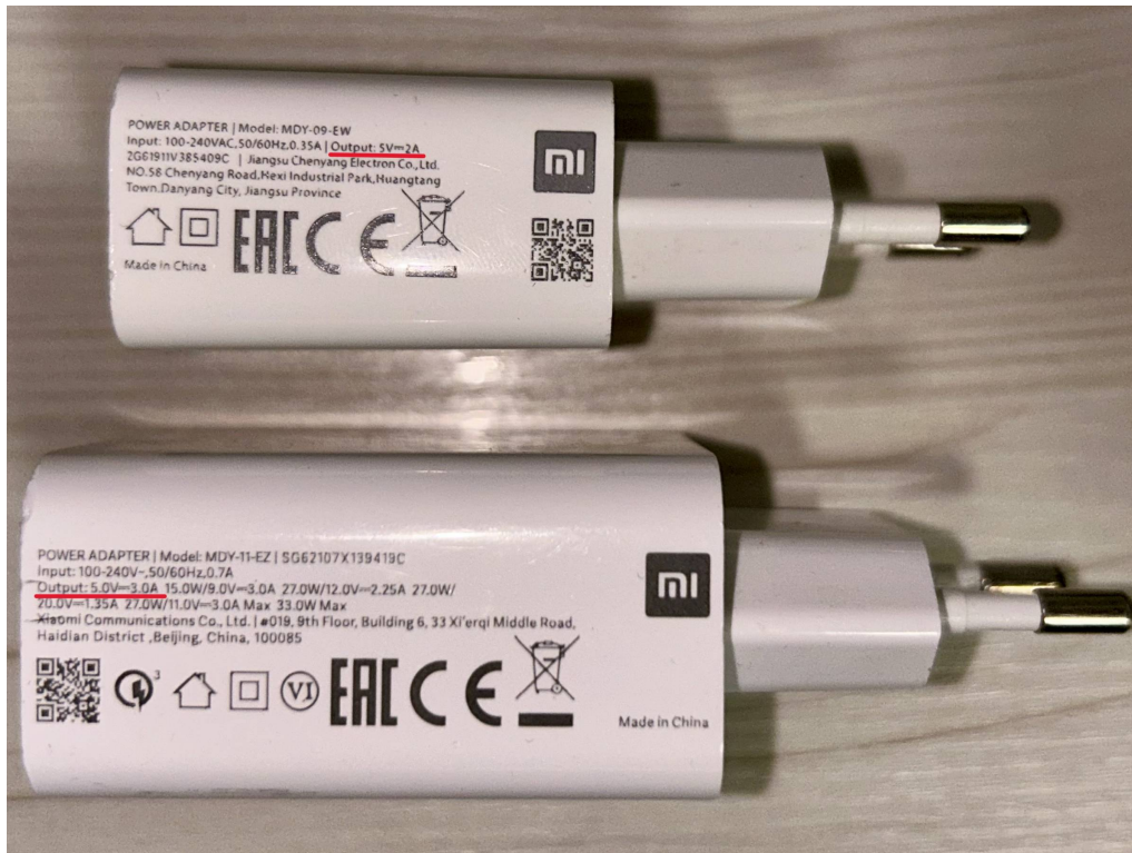
Figura 9.1: Cargadores Xiaomi empleados en el sistema (arriba: modelo MDY-09-EW, abajo: modelo MDY-11-EZ).
