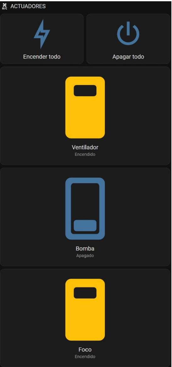
Figura 7.10: Visualización de los botones para el control de los actuadores.
