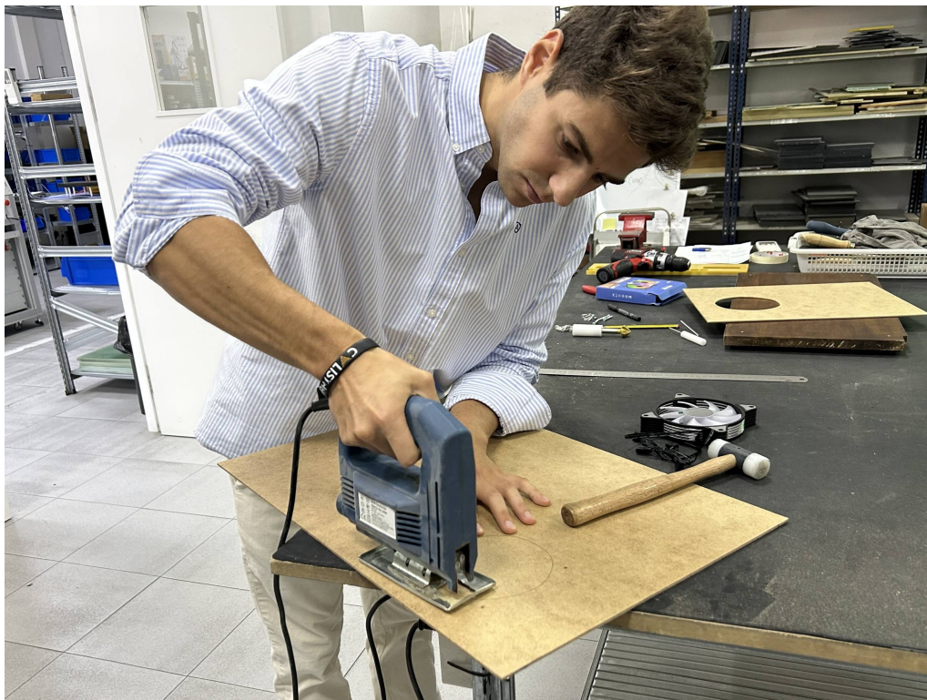
Figura 9.3: Proceso de corte inicial de la madera con sierra de calar.
