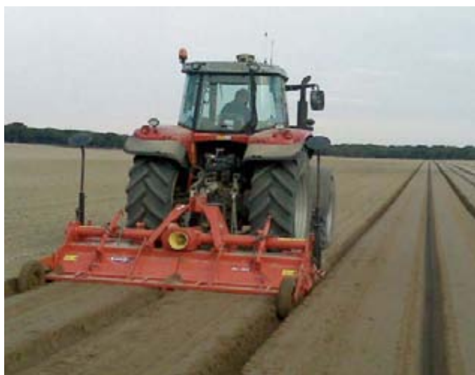
A una primera pasada del tractor le sucede una segunda separada de la primera por una distancia constante, que en este caso es la anchura del implemento del tractor.
