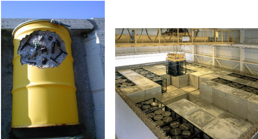
Figura 2: Bidón acondicionado con cemento (izquierda.). Celda de almacenamiento de contenedores (derecha.). [7]
