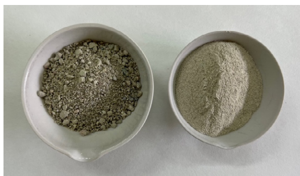
Figura 12: Arcilla original y arcilla molida y tamizada a < 1 \text{ mm} .
