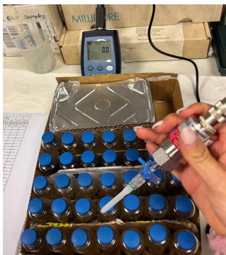
Figura 4.2 Manómetro digital para medir la presión de gas en los ensayos de fermentación in vitro.
