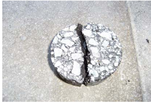
Fig. 1 Testigo roto a tracción indirecta
