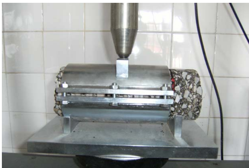
Fig. 2 Ensayo de corte (dispositivo B)
