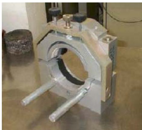
Fig. 3 Dispositivo A para el ensayo de corte
