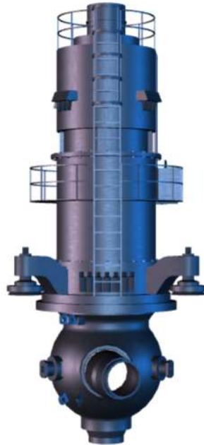
Ilustración 15. Representación de una bomba de refrigeración del reactor [33]
