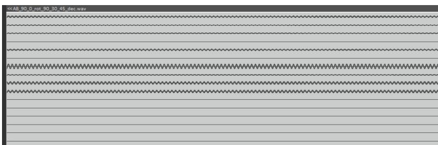
Figura 54. Forma de onda de una señal Ambisonics rotada y decodificada a 7.1.4 en Reaper.
