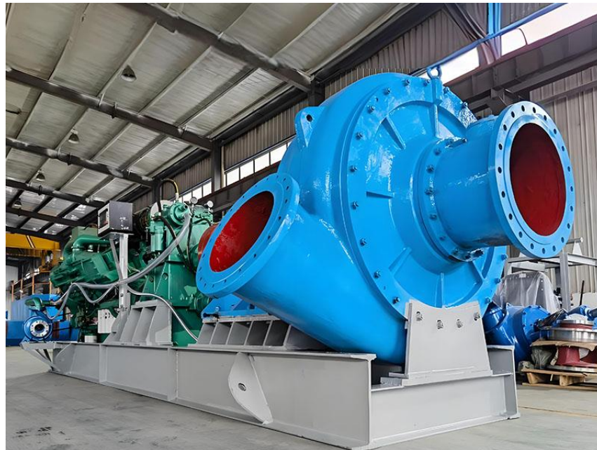
Ilustración 73. Bomba de dragado. Fuente: Ocean Pump.
