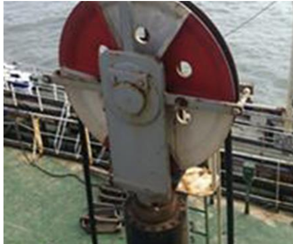
Ilustración 72. Compensador de olas.
