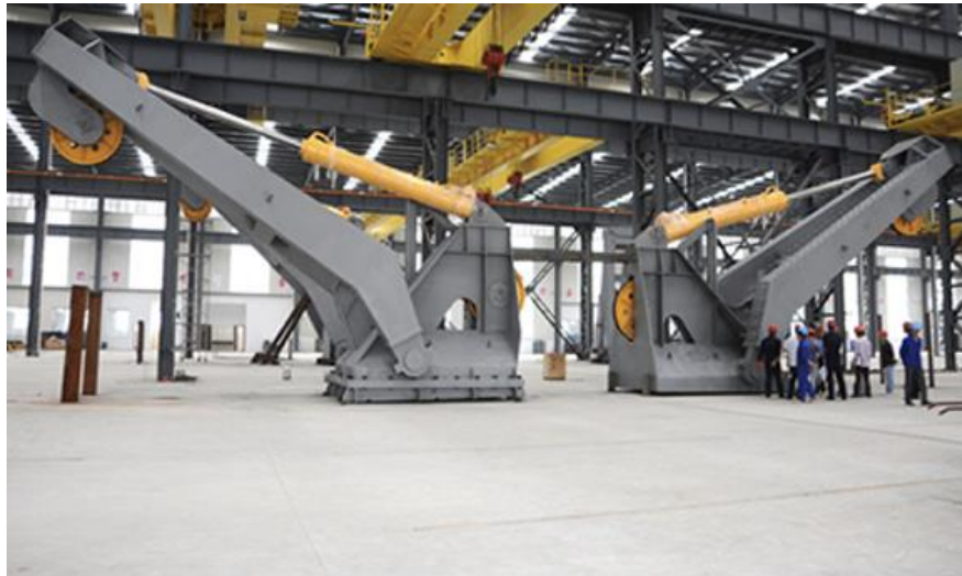
Ilustración 71. Grúas que sujetan la tubería de dragado durante la operación.
