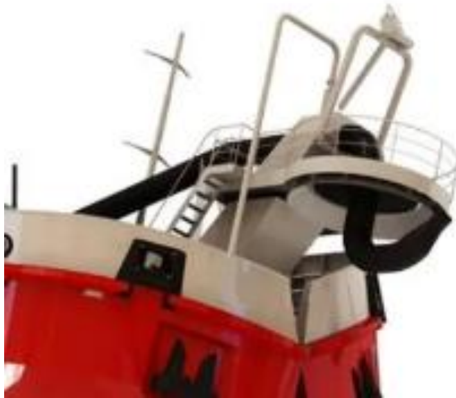
Ilustración 75. Descarga en arco iris y acoplamiento de proa.
