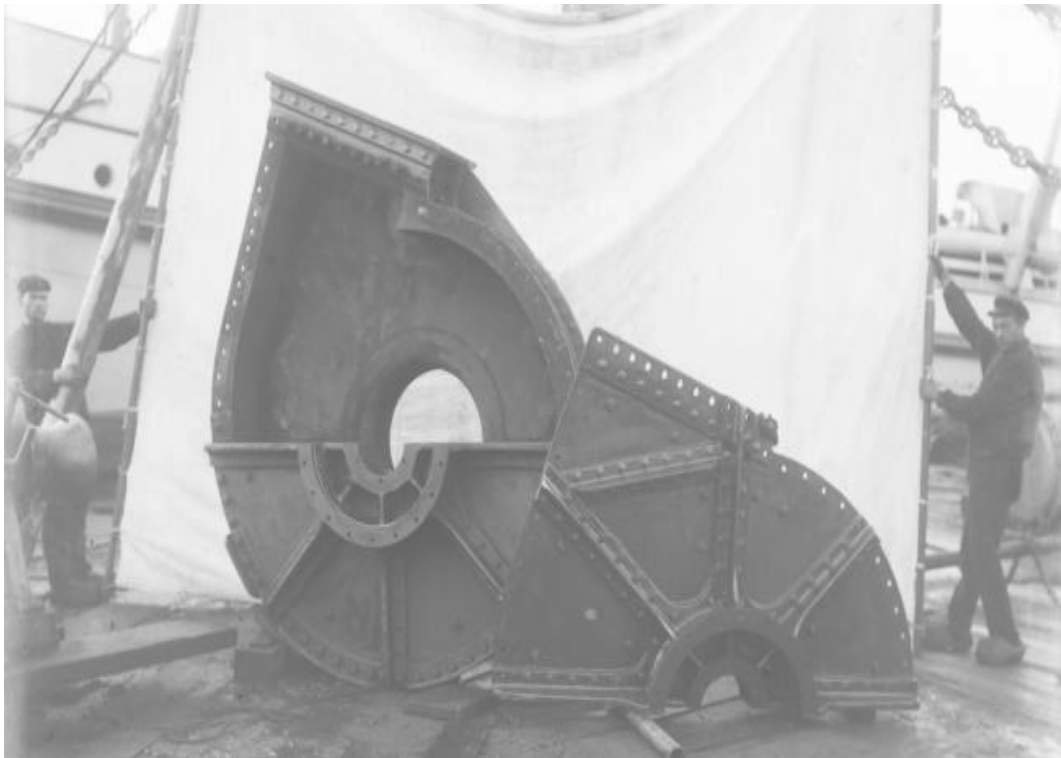
Ilustración 2. Voluta de la bomba centrífuga.
