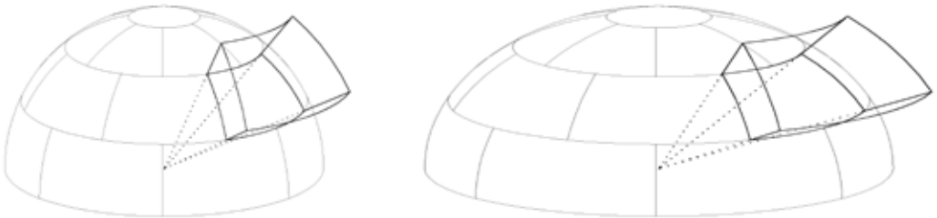
Figura 1. Despiece según paralelos y meridianos en una bóveda semiesférica (izquierda) y en una bóveda sobre planta elíptica (derecha).
