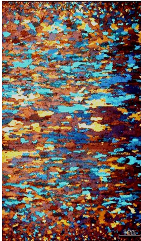
Figura 3: Micrografía óptica (20 Aumentos) en la que se observa la estructura de grano de la sección longitudinal de una bobina de aluminio tras la laminación en caliente con un ataque electroquímico. Cortesía de Cindal.
