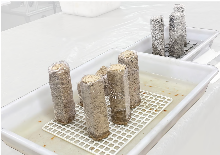
Figura 4.13. Fotografía propia. Ensayo de capilaridad ETSAM, 13 noviembre 2025
