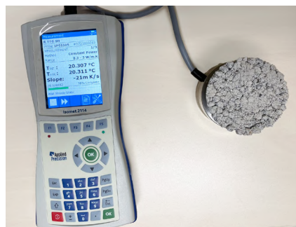
Figuras 4.15. Fotografías propias. Ensayo de conductividad térmica muestra R (izq.) y RC con musgo Sphagnum (dcha.) ETSAM, 16 diciembre 2025
