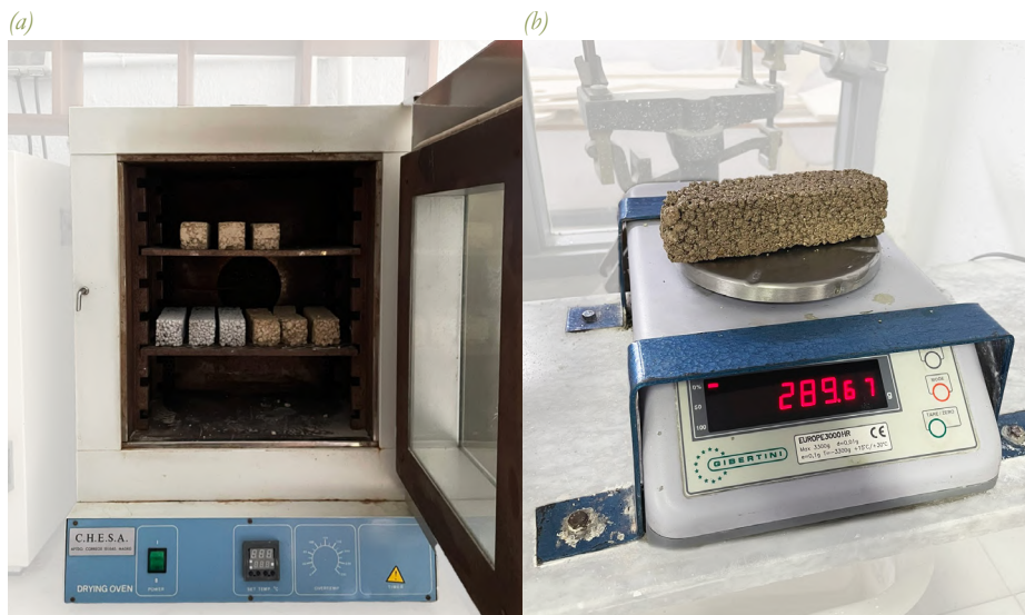
Figuras 4.10. Fotografía propia. (a) Probetas en estufa (b) Medición de peso de probetas ETSAM, octubre 2025
