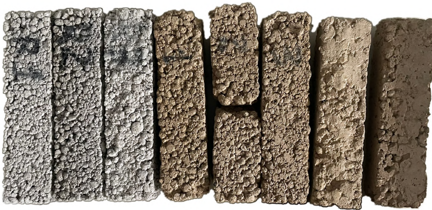
Se observa la fragilidad de la segunda probeta RC, debido a la incorporación de posos de café.
