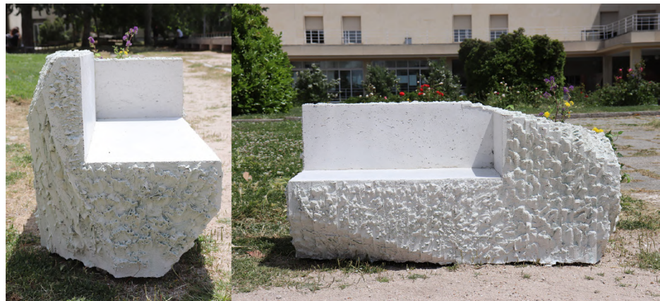
Figura 1.1. Fotografías propias. Banco de Hormigón bioreceptivo, Taller Experimental II Hormigón Concreto 2024. ETSAM, mayo 2024
