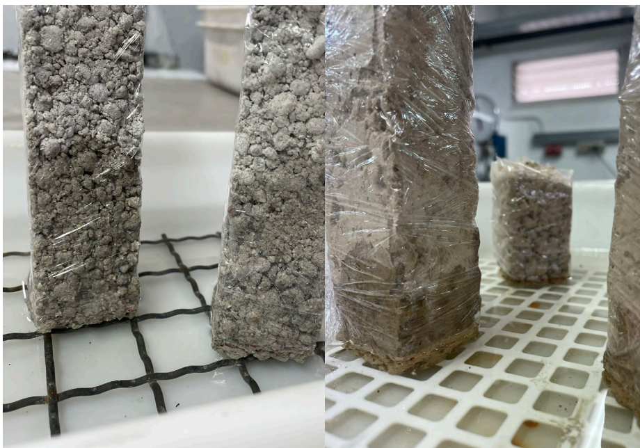
Figuras 4.14. Fotografías propias. Capilaridad muestra R (izq.) y RC-RCsa (dcha.) ETSAM, 13 noviembre 2025
