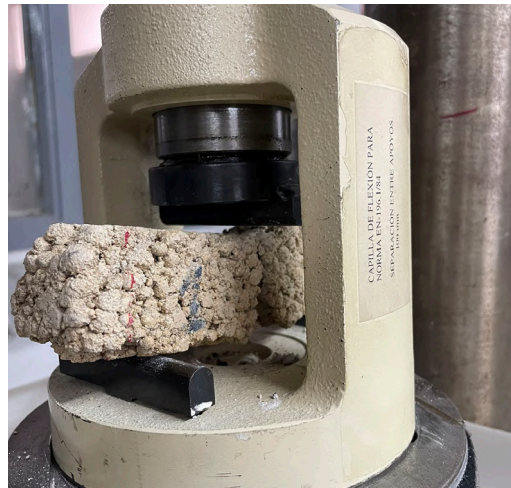
Figura 4.11. Fotografía propia. Ensayo de flexión ETSAM, 23 noviembre 2025
