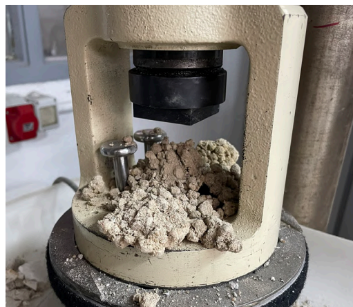
Figura 4.12. Fotografía propia. Ensayo de compresión ETSAM, 23 noviembre 2025
