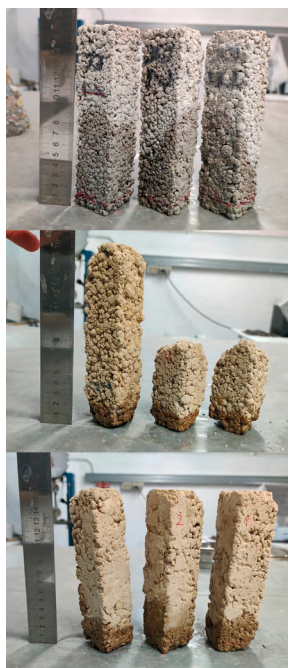
Figuras 4.22. Fotografías propias. Medición ascenso por capilaridad muestras R (1ª), RC (2ª) y RCsa (3ª)
