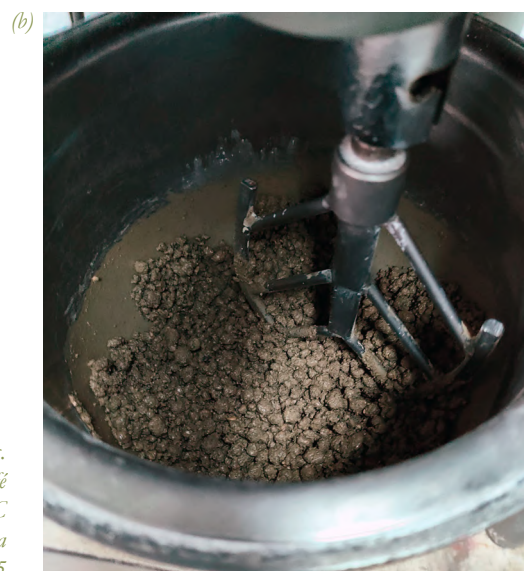
Figuras 4.6. Fotografías propias. (a) Incorporación posos de café (b) Mezcla RC (c) Marca de café utilizada ETSAM, 21 octubre 2025
