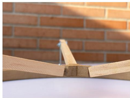
Fig. 45 Colapso de un rosetón, de arriba a abajo. 1) Rosetón sin carga. 2) Inicio del desplazamiento, grieta pequeña. 3) Rosetón a punto del colapso, grieta más visible. 4) Colapso del rosetón. Vídeo pulsando en la imagen. Elaboración propia.
