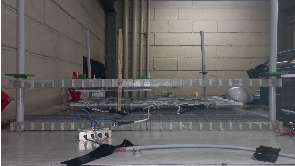
Figura 5.9: Montaje en el laboratorio de las bobinas DD-D del enlace Tx-Drone.
