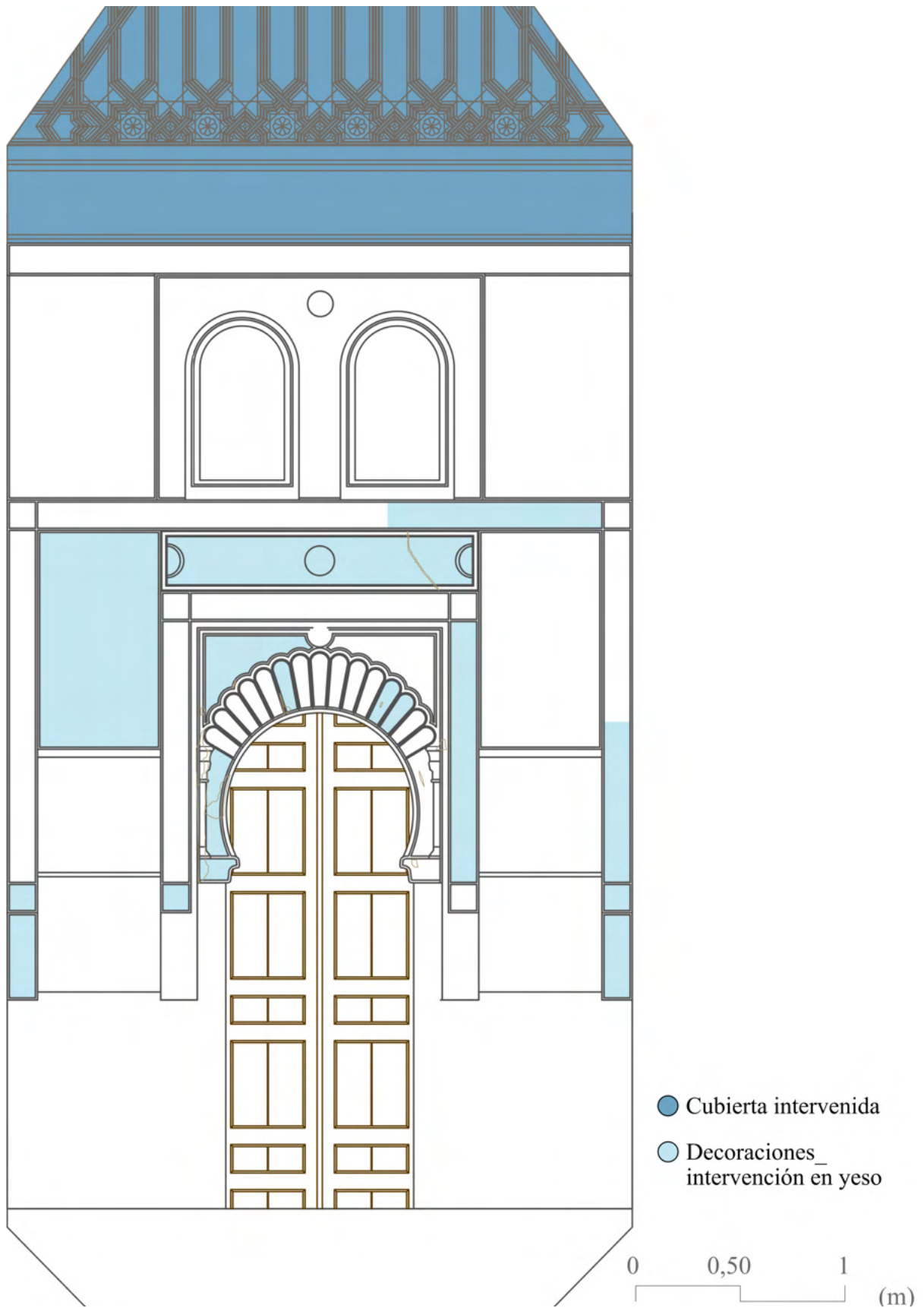
Figura 53: Elementos afectados del alzado interior de la entrada al oratorio por la intervención de Federico Wulff Barreiro.
