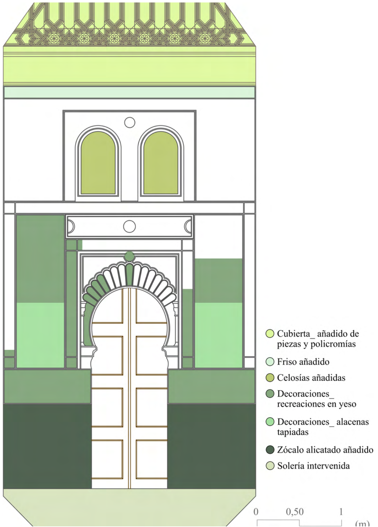
Figura 29: Elementos afectados del alzado interior de la entrada al oratorio por la intervención de Rafael Contreras.
