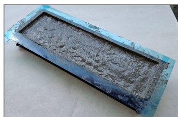
Figura 5 Aplicación del refuerzo EMP160 sobre el premolde.
