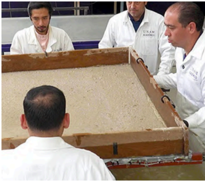
Fig 59. Fuente: Canal youtube noticias el debate. Fotografía proceso de creación del papel a partir de pulpa del alga.
