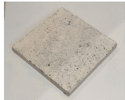
Fig 165. Fuente: elaboración propia. Fotografía probeta 01.02.03 con un 10 % de alga.
