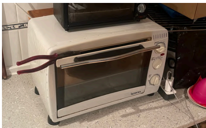
Fig 124. Fuente: Elaboración propia. Fotografía del horno 1 utilizado para secado, capacidad 200g.
