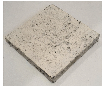
Fig 166. Fuente: elaboración propia. Fotografía probeta 01.02.03 con un 16,25 % de alga.
