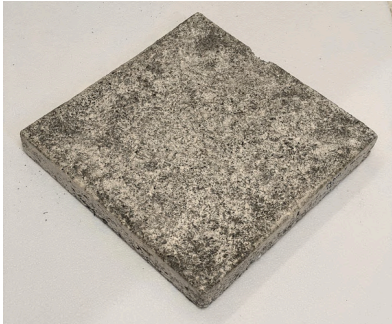
Fig 161. Fuente: elaboración propia. Fotografía probeta 01.01.02 con un 10 % de alga.
