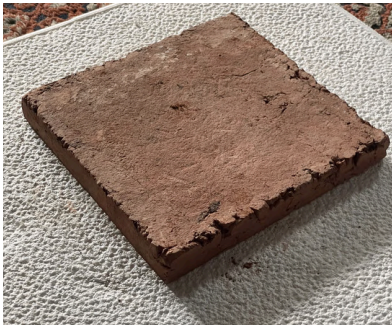
Fig 161. Fuente: elaboración propia. Fotografía probeta 03.02.01 con un 10 % de alga.
