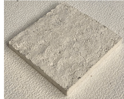
Fig 164. Fuente: elaboración propia. Fotografía probeta 01.02.03 con un 10 % de alga.
