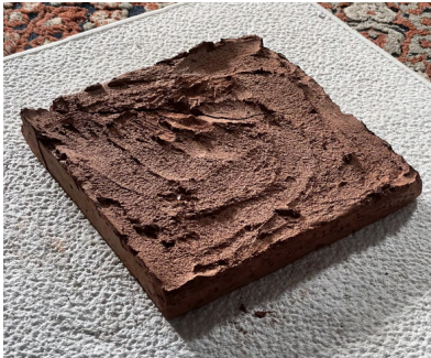
Fig 160. Fuente: elaboración propia. Fotografía probeta 03.01.02 con un 16 % de alga.
