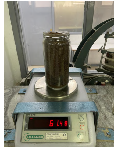
Fig 115. Fuente: elaboración propia. Valanza de pesado marcando una de las marcas registradas tras el secado.
