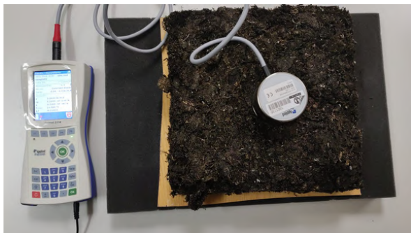
Fig 177. Fuente: elaboración propia. Fotografía aparato de medición Isomet 2114 junto a probeta 05.02.03.
