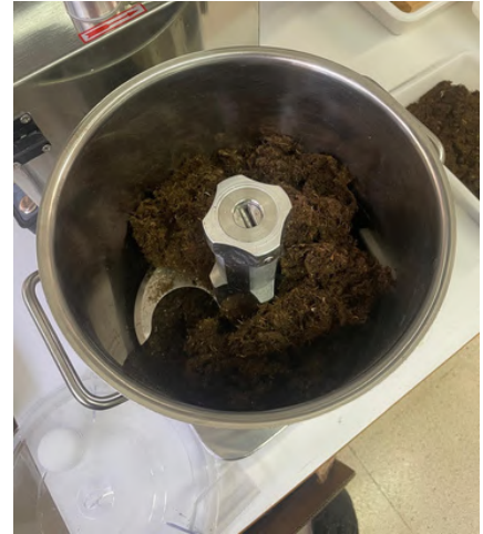
Fig 112. Fuente: elaboración propia. Alga en fibras en el interior del molino de triturado.
