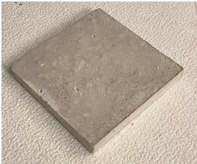
Fig 162. Fuente: elaboración propia. Fotografía probeta 01.01.03 con un 10 % de alga.
