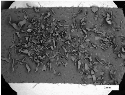
Fig 145. Fuente: elaboración propia. Imagen del alga en polvo bajo BSE con un aumento del 25.
