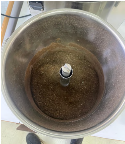
Fig 113. Fuente: elaboración propia. Alga en fibras en el interior del molino tras el triturado.
