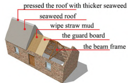
Fig 34. Fuente: web tandfonline. Dibujo partes que componen las cubiertas de Jiaodong.
