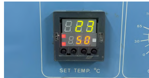
Fig 109. Fuente: Elaboración propia. Fotografía del medidor de temperatura y tiempo, en rojo la temperatura.
