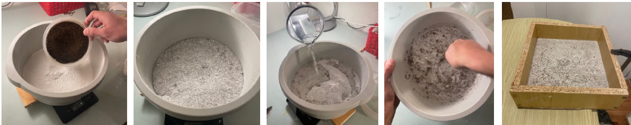
Fig 159. Fuente: elaboración propia. Fotografía probeta 01.01.01 con un 6 % de alga.
