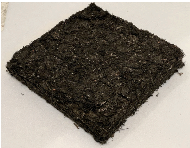
Fig 165. Fuente: elaboración propia. Fotografía probeta 05.02.02 100 % alga.
