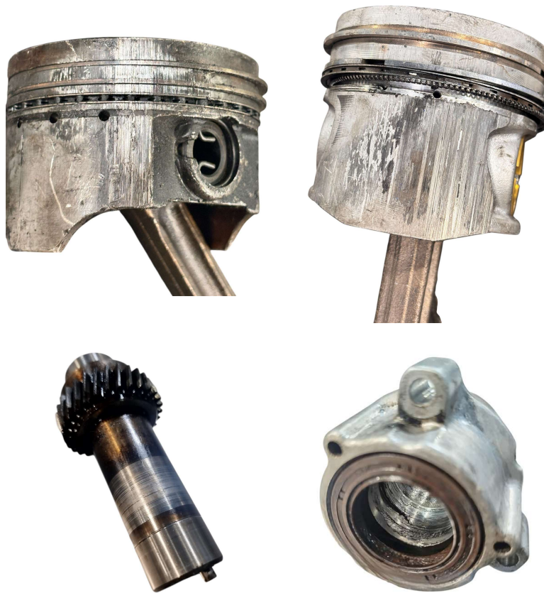
Figura 1. Ejemplos de contactos lubricados con fallo por gripado: pistón, árbol y cojinete
