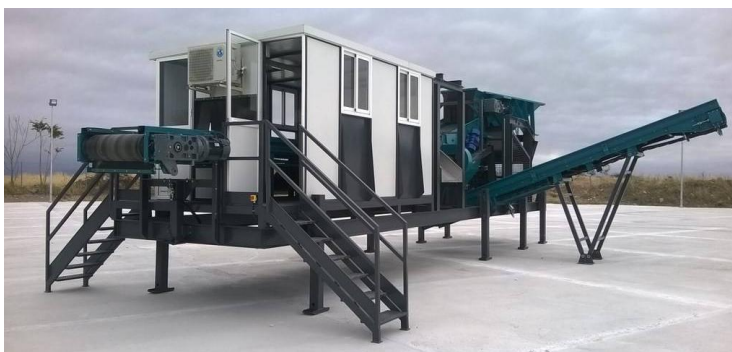
Fig 3.31. Maquinaria de planta semi-modular de tratamiento
