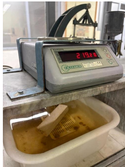
Fig 6.61. Peso en balanza sumergida
