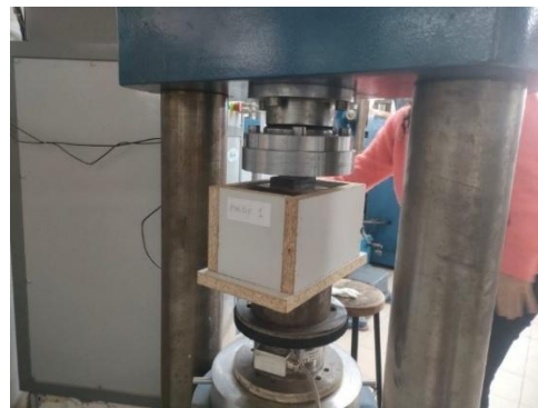
Fig 6.46. Prensado hidráulico del ladrillo 1
