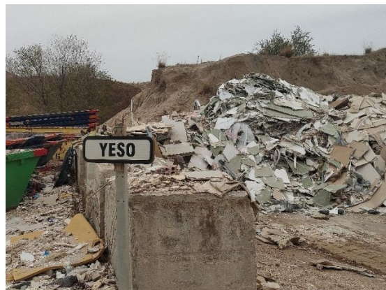
Fig 3.16. Escombros de yeso separados
