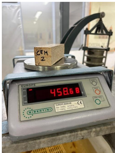
Fig 6.60. Peso saturado de la probeta
