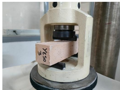
Fig 6.63. Probeta Yes-F sometida a flexión
