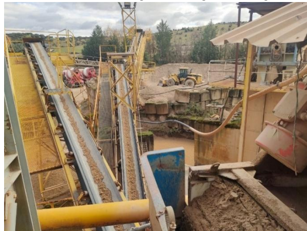
Fig 3.72. Cintas transportadoras de material
