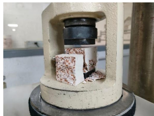
Fig 6.66. Probeta Cem-G sometida a compresión
