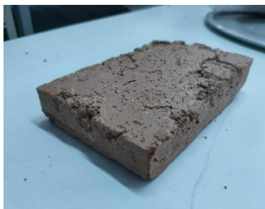
Fig 6.48. Ladrillo 2 (yeso + res. fino)
