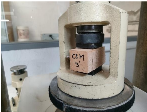
Fig 6.65. Probeta Cem-F sometida a compresión
