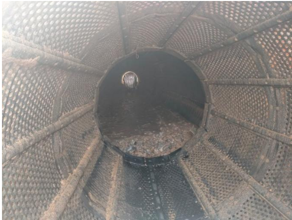
Fig 3.70. Trómel lavador de áridos
