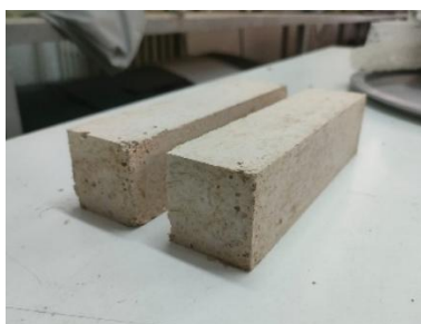
Fig 6.53. Probetas (cemento + res. grueso)
