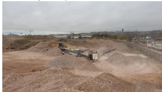
Fig 3.77. Trituradora y clasificadora móvil
