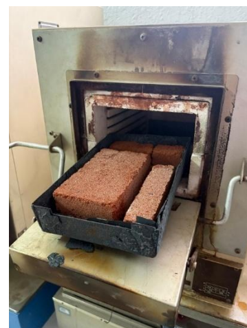
Fig 6.57. Salida del horno del ladrillo
