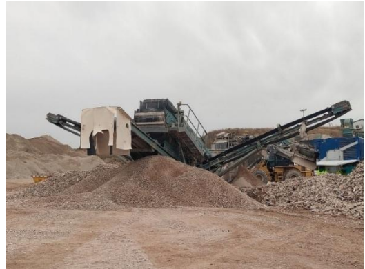
Fig 3.44. Trituradora y clasificadora móvil de RCD
