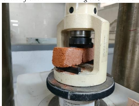
Fig 6.64. Probeta Arc-F sometida a flexión
