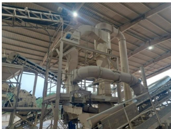
Fig 3.48. Separador neumático de residuos ligeros
