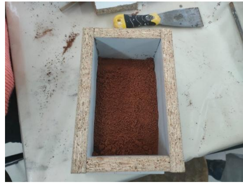
Fig 6.42. Vertido en el molde y prensado manual
