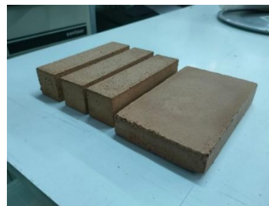
Fig 6.49. Ladrillo 3 (cemento + res. fino)
