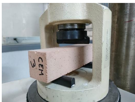
Fig 6.62. Probeta Cem-F sometida a flexión
