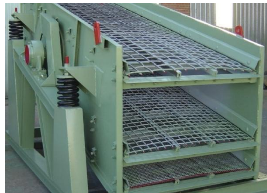
Fig 3.45. Criba vibratoria con diferentes tamaños
