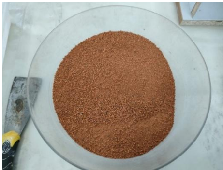
Fig 6.37. Mezcla en seco de arcilla y residuos
