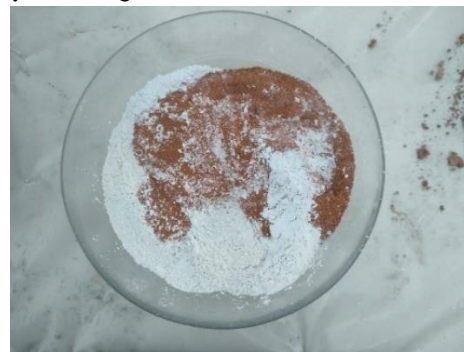
Fig 6.38. Mezcla en seco de cemento blanco y residuos
