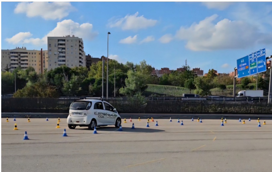
Figura 2.4: Prueba en entorno real con el Mitsubishi i-MiEV modificado del INSIA.
