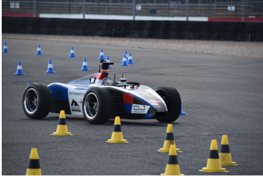
Figura 2.5: ADS-DV con los sensores de UPM Racing instalados (FSUK 2024)
