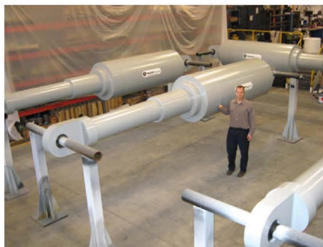
En la imagen, un amortiguador viscoso del fabricante Taylor
