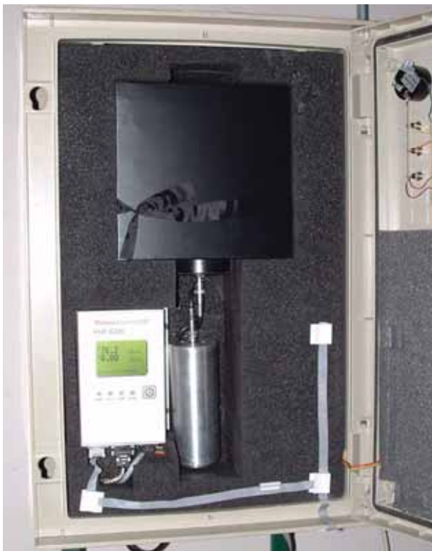
FIGURA 4. Sistema de detección FHT-1372 de Thermo Eberline. El interior está provisto de un detector de grandes dimensiones de PVT con su electrónica asociada.
