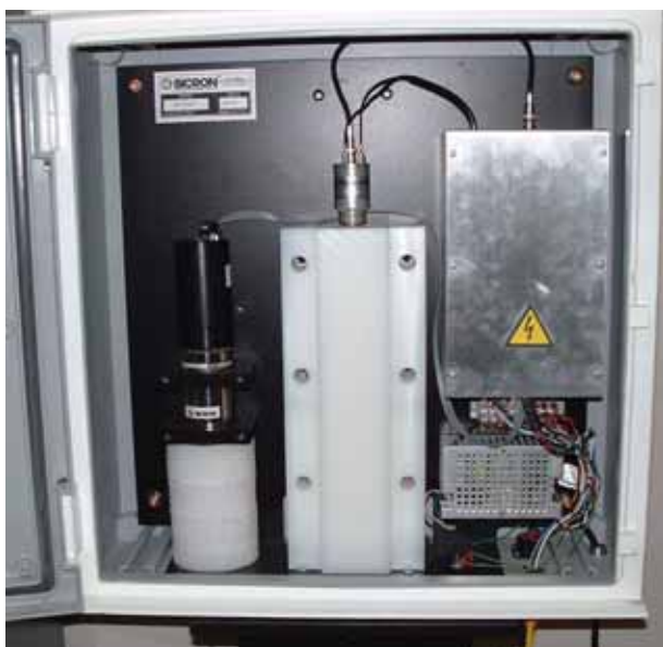
FIGURA 2. Sistema de detección APM de Bicron. En su interior se observa el detector de NaI(Tl) y la electrónica asociada.
