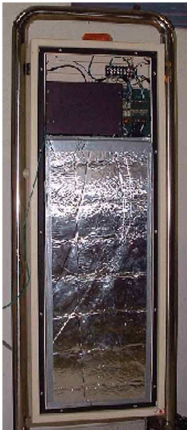
FIGURA 3. Sistema de detección GR-606 de Exploranium. El interior está provisto de un detector de grandes dimensiones de PVT con su electrónica asociada.
