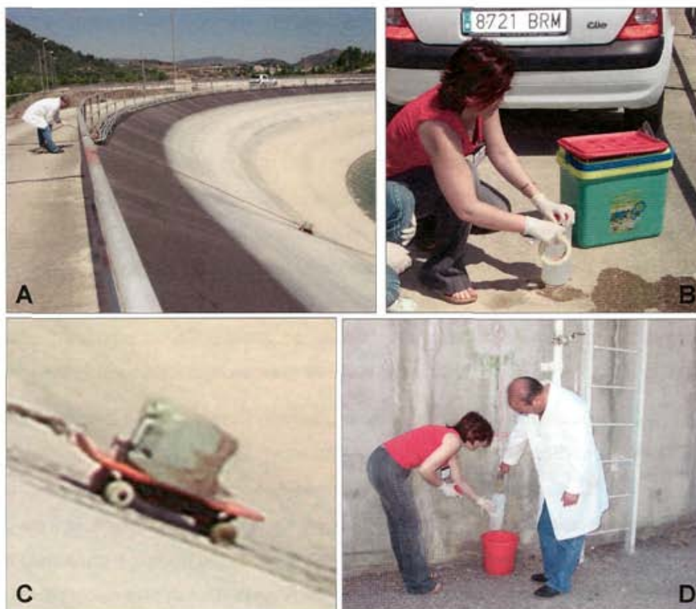
Figura 8. Fotografías de la toma de muestras de agua del sistema de circulación de la Central Nuclear de Cofrentes. A: Toma de muestra de agua de la balsa de vertidos. B: Envase de plástico estéril utilizado para recoger las muestras. C: Dispositivo utilizado para recoger el agua de las balsas de vertido. D: Toma de muestra de agua de los tanques de hormigón a través del grifo exterior.
