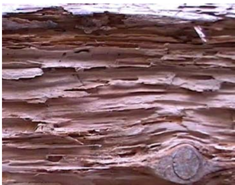
Fig. 3.2.A/2. Madera atacada por termites. La madera con menor cantidad de celulosa, como la de verano y los nudos, permanece, mientras que la madera de primavera ha desaparecido. En algunas galerías se observan restos arenosos o de barro
