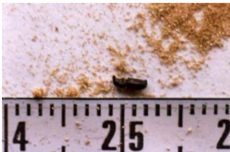
Fig. 4.2.B/3. Junto los restos de madera es frecuente encontrar resto de adultos. Un cuerpo, o alguna parte suficiente de él, permite su identificación prácticamente igual que si el insecto estuviera íntegro (curculiónido, en este caso)
