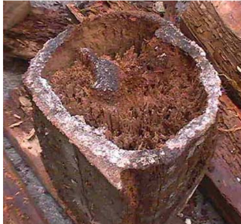
Fig. 2.1.A/3. Pie derecho atacado por termes. El ataque deja la superficie perimetral de la pieza relativamente íntegra, pues los termes huyen de la luz, pero con el interior de la pieza prácticamente vacío
