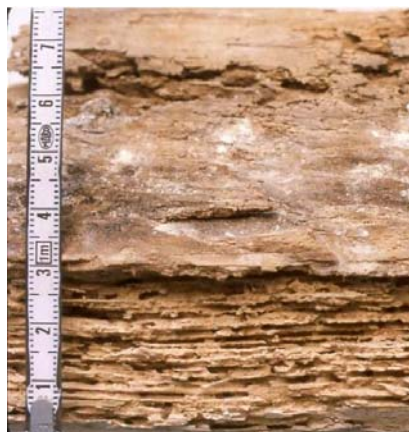
Fig. 2.1.A/2. Madera atacada por coleópteros (curculiónidos, en este caso), y galerías de las larvas (tercio inferior de la imagen). En la parte central de la pieza pueden observarse, también, micelios micóticos, y más arriba la pudrición de la madera
