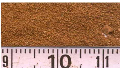
Fig. 4.2.B/4. El serrín que queda en el interior de la madera también puede servir para discriminar unas especies de otras (de curculónido, en este caso)
