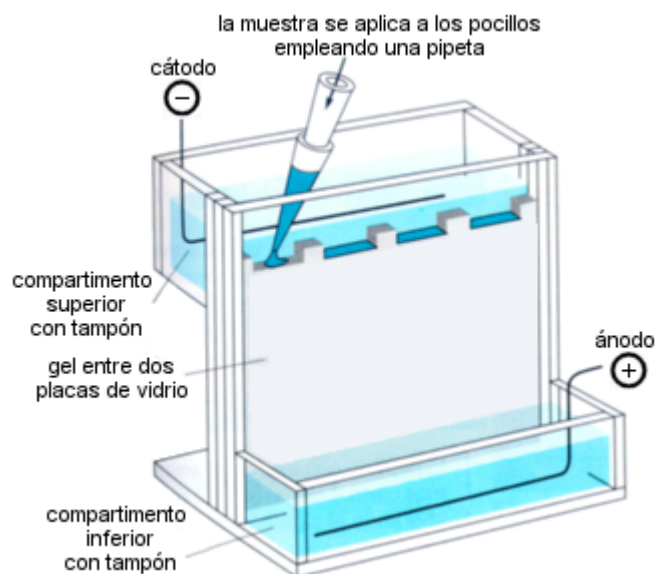
Figura 10. Llenado de los pocillos del gel de poliacrilamida. 12
